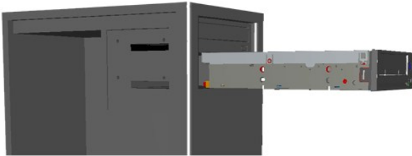
图 5：安装内部磁带驱动器
