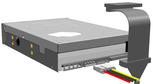
图 6：将电缆连接到磁带驱动器
